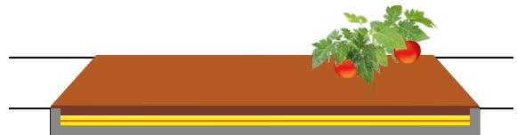
**7** После установки нагревательной секции систему включают в электрическую сеть 220 В, 50 Гц. В целях безопасности нагревательная секция должна быть заземлена и подключена к электрической сети через устройство защитного отключения (УЗО).
