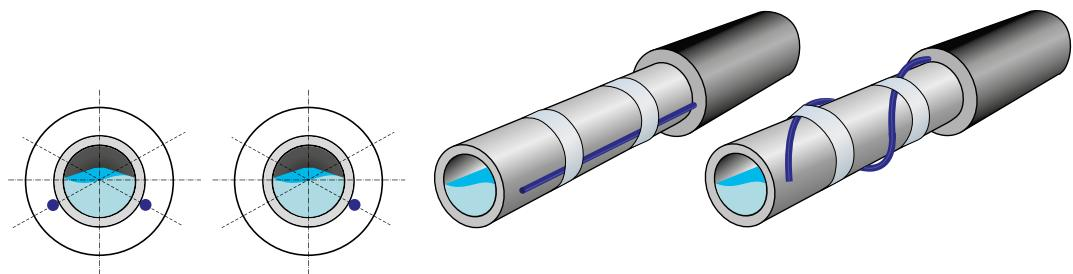
**1** Перед монтажом нагревательного кабеля, для предотвращения повреждения системы, необходимо убедиться в том, что на соответствующем участке трубы и вокруг неё нет острых кромок, острых наплывов сварочных швов. Труба должна быть сухой и чистой для более качественного контакта кабеля с поверхностью.
