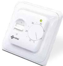
Электронный аналоговый терморегулятор для регулирования температуры путем включения/отключения нагрузки (нагревательной секции). В комплекте имеется термодатчик (NTC) с отрицательным температурным коэффициентом. RTC 70.26 – простой в эксплуатации электронный терморегулятор. Имеет тумблер включения, индикатор состояния и ролик установки температуры.
