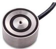
Предназначен для установки в грунт на открытых площадках. Регистрирует температуру и влажность. Монтируется в местах наибольшего образования снежных и ледяных покровов. Датчик устанавливается на твердое бетонное основание, верхняя часть датчика должна быть на одном уровне с поверхностью грунта. В местах, где используется асфальтовое покрытие, датчик должен быть установлен в бетонном углублении.
