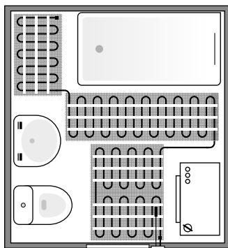
Не рекомендуется устанавливать стационарную мебель, укладывать ковры и любые другие предметы на участок пола со смонтированной нагревательной системой.
