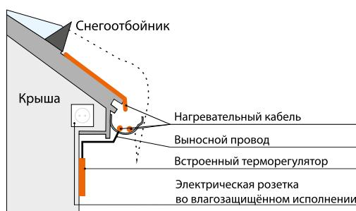
Встроенный терморегулятор НЕОБХОДИМО размещать в затянутом месте — под элементами кровли. Для корректной работы нагревательной системы НЕ РЕКОМЕНДУЕТСЯ размещение терморегулятора в следующих местах:
