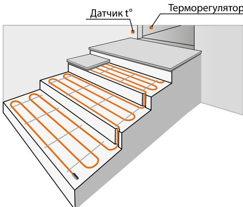
Кабель нагревательной секции укладываются на подготовленную поверхность перед укладкой плитки или финишной бетонной заливкой.
